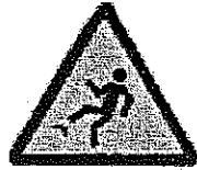
Caida a distinto nivel
